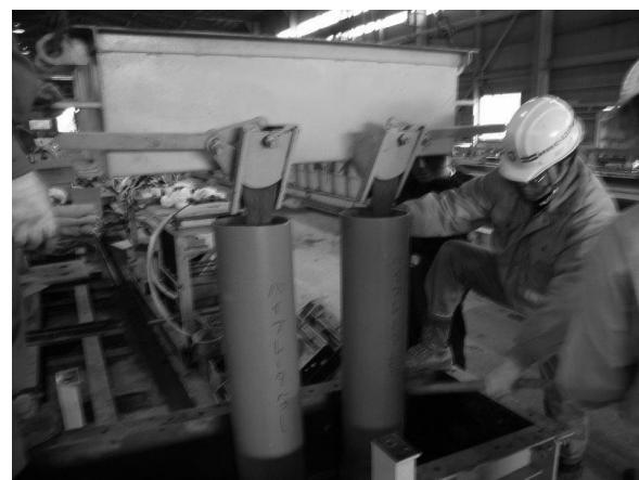
写真-解5.3.1 鋼繊維の分散試験状況
