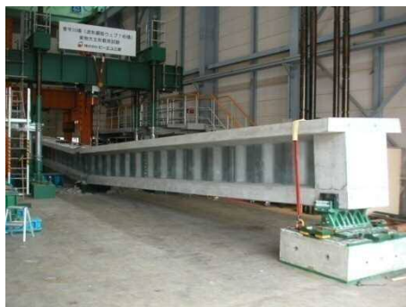
試験後の主桁供試体
