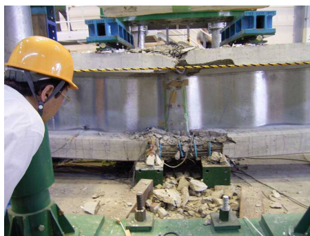
主桁供試体破壊状況
