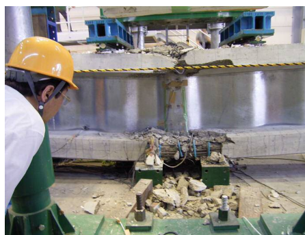
主桁供試体破壊状況
