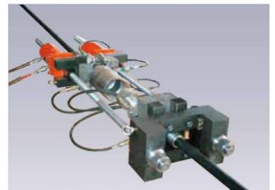
写真-1 引き寄せジャッキ
