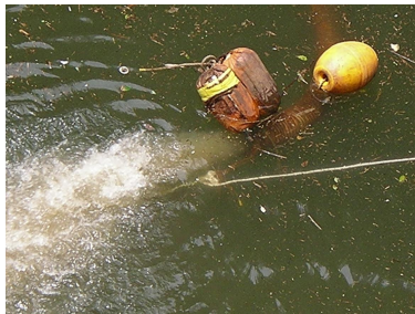
写真-3 ポンプ排出状況
