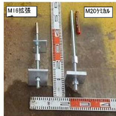
写真-7 固定用アンカー
