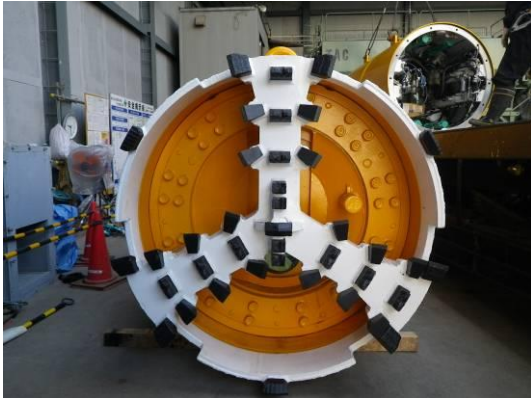
写真-1 シールド機面盤 (スポーク型)
