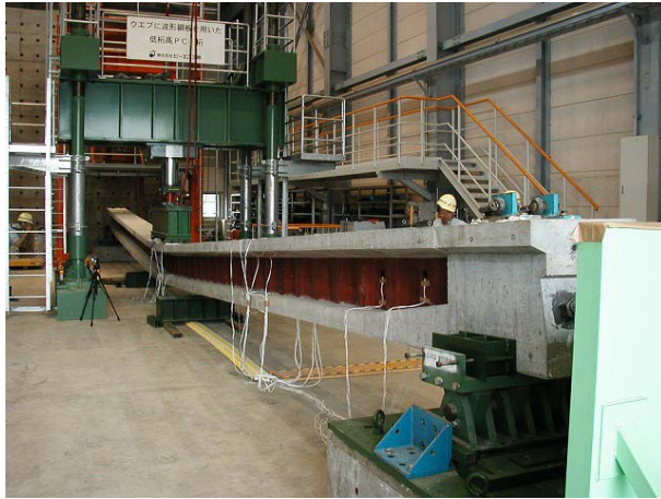
写真-5 破壊状況(全景)
