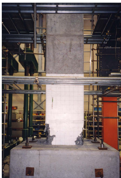
写真-1 供試体破壊状況(1)
