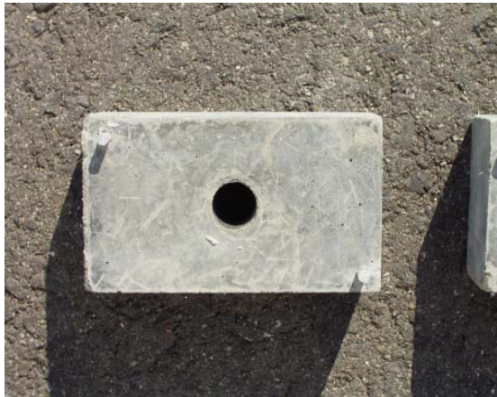
写真-3 試験終了後の支圧板背面
