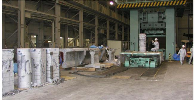
写真-1 一軸圧縮強度試験の状況
