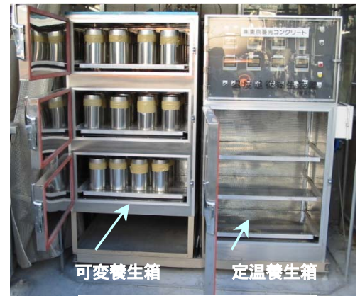
図-2 温度制御装置
