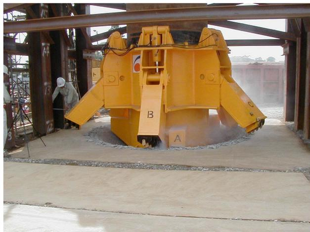
写真-4 拡翼掘削状況
