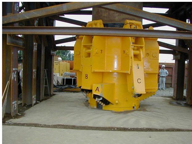
写真-3 マルチアーム型拡翼岩盤掘削ビット
