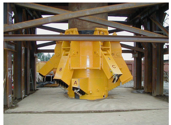
写真-4 掘削ビット全開状態
