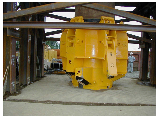
写真-3 掘削ビット閉状態
