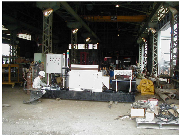
写真-7 拡翼ビット開閉用油圧
