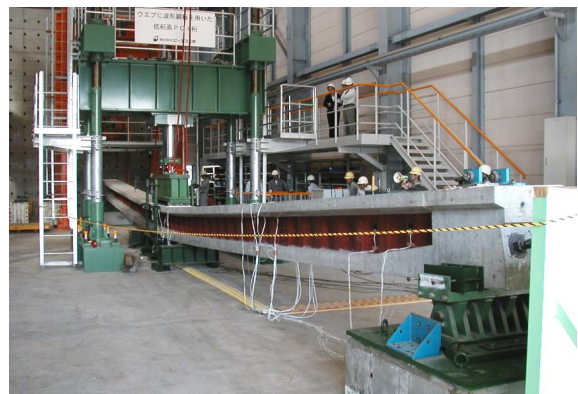
写真-2 鉛直載荷試験システム
