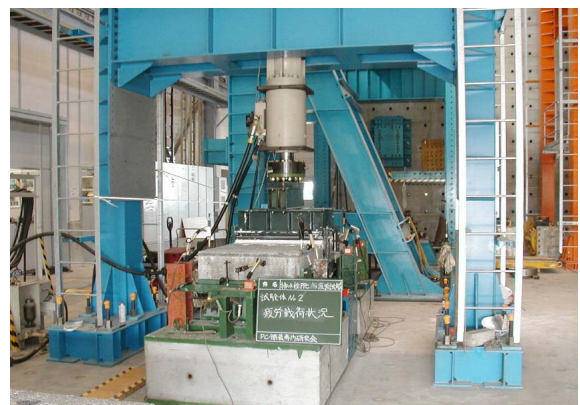
写真-3 疲労載荷システム
