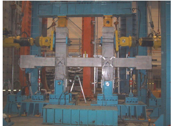
写真-1 アクチュエータ構造物試験システム
