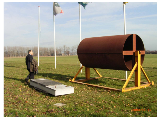
写真-1 ロール舗装巻取機
