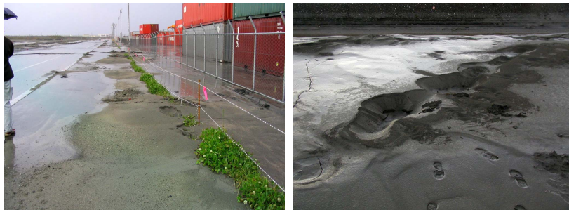
(4) 道路脇の噴砂孔列 (3) 写真(1)の左脇の噴砂脈
