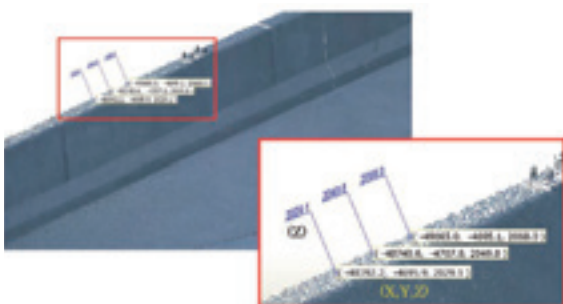
図-4 上床版の座標値計測例
