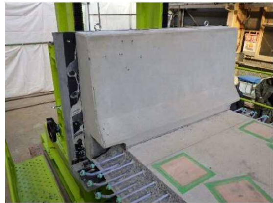
写真-4 フルキャスト壁高欄の試験製作
