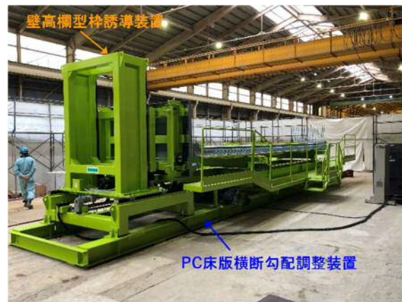
写真-3 フルキャスト壁高欄製造装置
