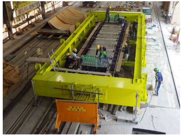
写真-2 PCaPC 床版の試験製作
