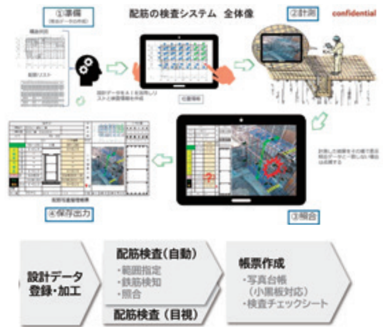
図-1 「配筋検査システム」の全体像
