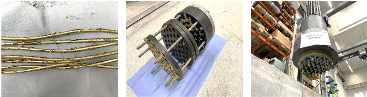
(疲労試験後 スtrand破断なし)
