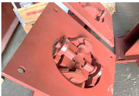
写真-23 リセスパイプ保持金物
