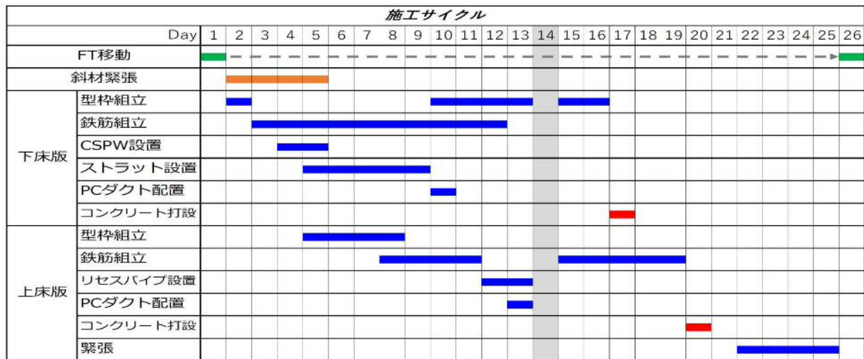
図-15 張出しサイクルの詳細工程
