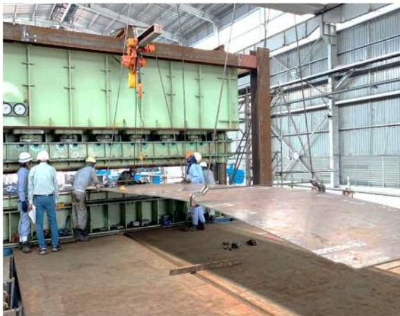
写真-5 曲げ加工機による波形鋼板の加工状況
