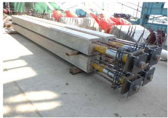
写真-11 製作したプレキャストストラット
