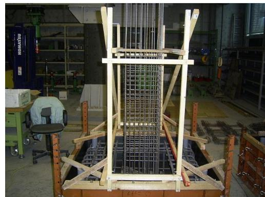
写真-4 供試体 No.2 配筋状況
