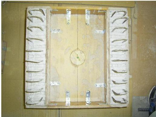
写真-1 供試体 No.1 ループ継手
