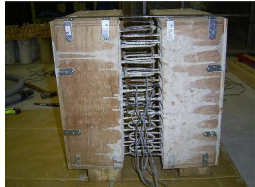
写真-2 供試体 No.1 ループ継手組立
