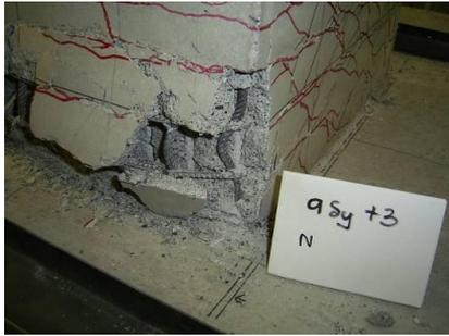
写真-10 供試体 No.2 破壊状況
