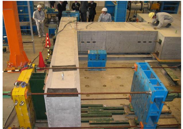
写真-4 底版との接合試験状況
