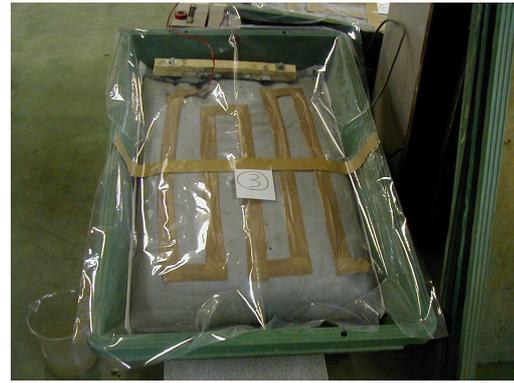
写真-1-2 袋体の荷電試験状況
