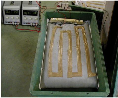
写真-1-1 袋体の荷電試験状況
