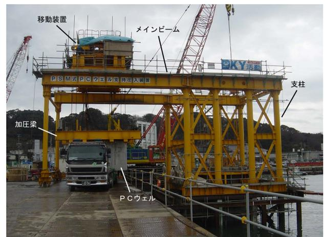
写真-2 支持圧入装置 全景
