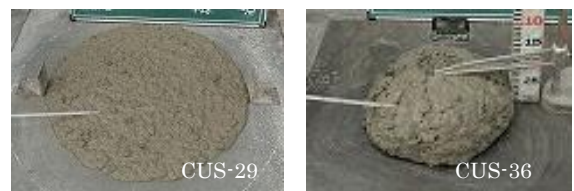
写真-1 フレッシュコンクリートの試験状況
