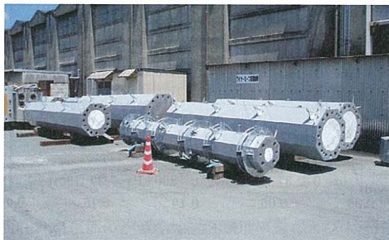
写真-13 プレキャストセグメント完成状況
