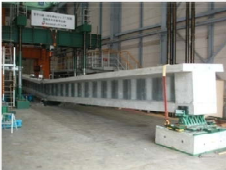
試験後の主桁供試体
