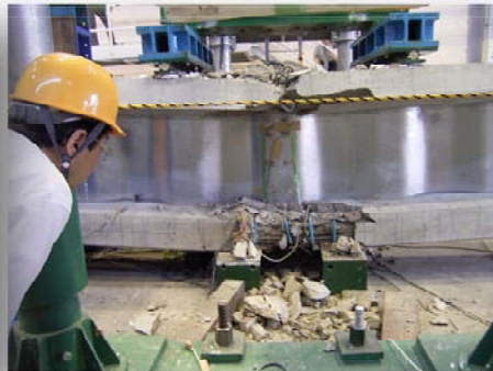
主桁供試体破壊状況
