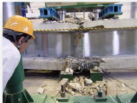
主桁供試体破壊状況
