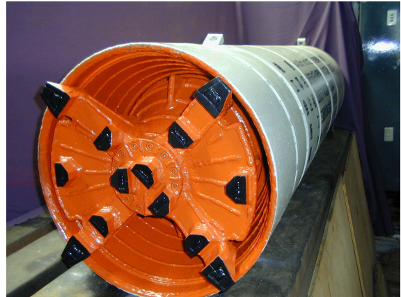
写真 - 3 掘進機前面
