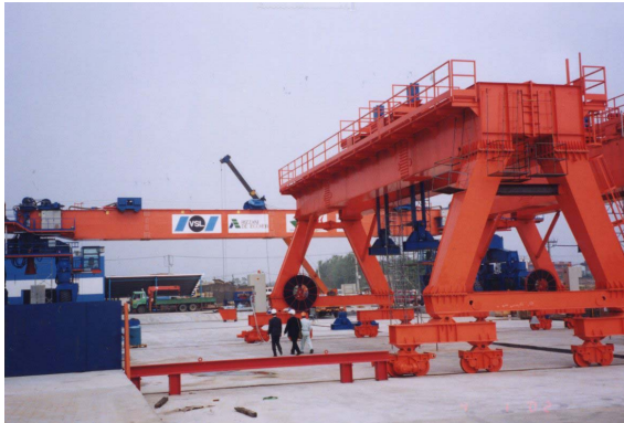
写真 - 4 桁吊り用門形クレーン
