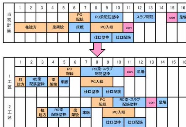
図-2 PC 工事サイクル工程
