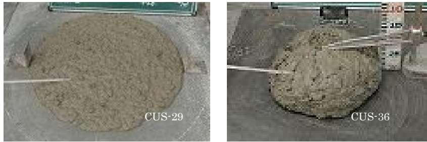
写真-2 フレッシュコンクリートの試験状況
