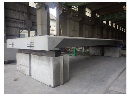
写真-5 床版部材外観
