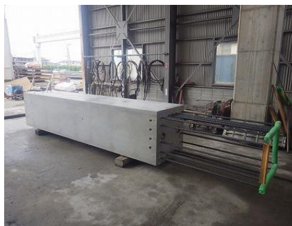
写真-4 柱部材外観
