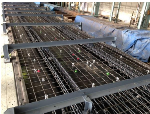
写真-11 インサート配置状況
