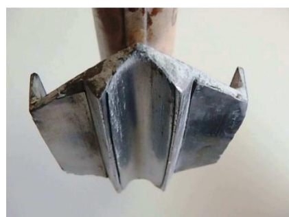
写真-55 本工事で作成した 専用目地コテ (保存)
