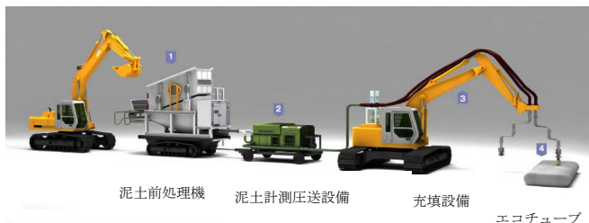
図-1 移動型 SPAD システム概要図
