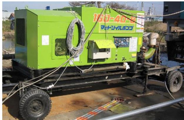
写真-9 泥土圧送ポンプ（泥土計測設備内蔵型）
