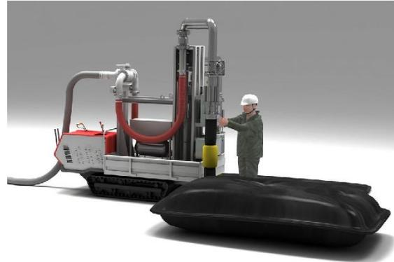
図-3 放射性物質汚染土充填用設備概要図
