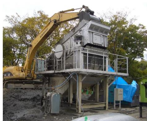
写真-6 定置型泥土前処理機施工状況
