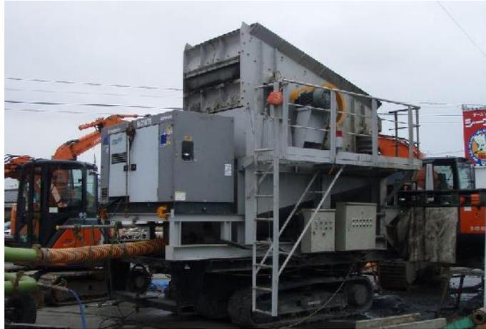
写真-4 自走式泥土前処理機施工状況
