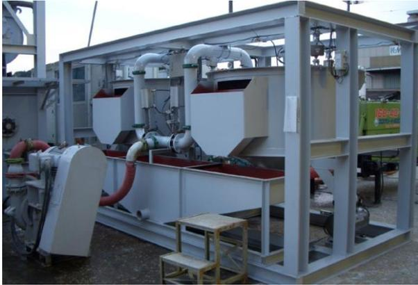
写真-7 定置型泥土計測設備
