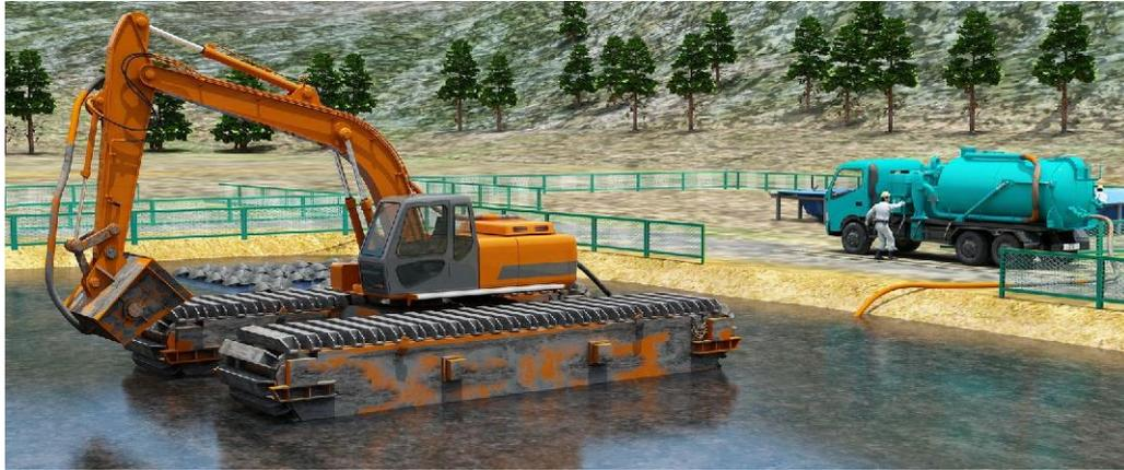
図-2 薄層浚渫設備概要図
