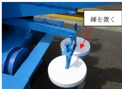
写真-6 専用錘の設置
