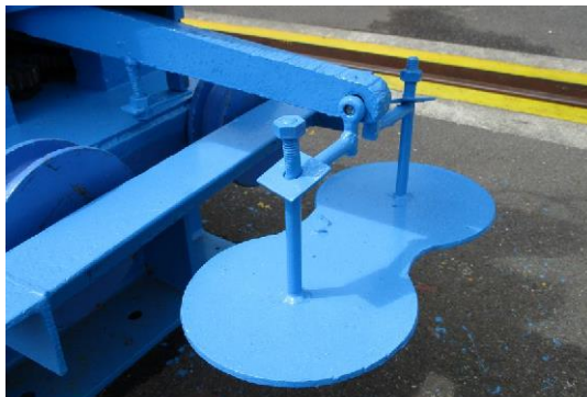
写真-6 錘の設置箇所
