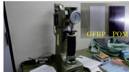
写真-4 試験状況 (ASTM D785)
