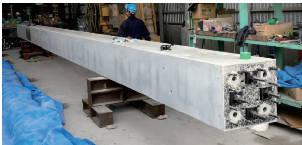
写真-2 PCaPC柱出来形(柱頭側)
