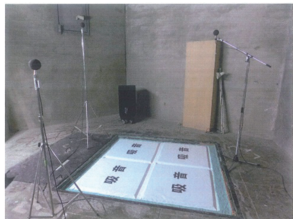
写真-2 音響透過損失試験状況
