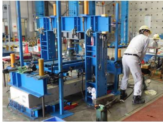
写真-4 二面せん断試験 荷重状況
