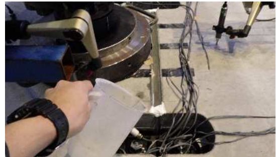
写真-3 載荷時の水張り状況
