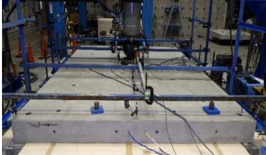
写真-2 定点疲労載荷試験状況
