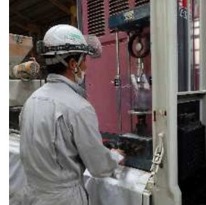
写真-4 材齢 2 時間圧縮強度測定状況
