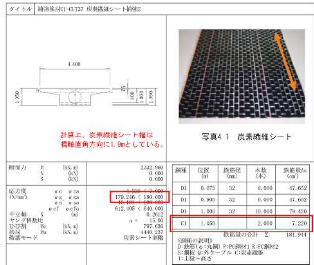
図-16 補強量算定結果(RC断面計算)
