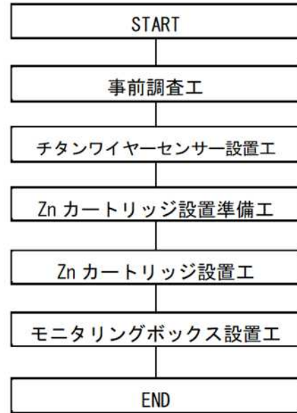
図-3 施工フロー
