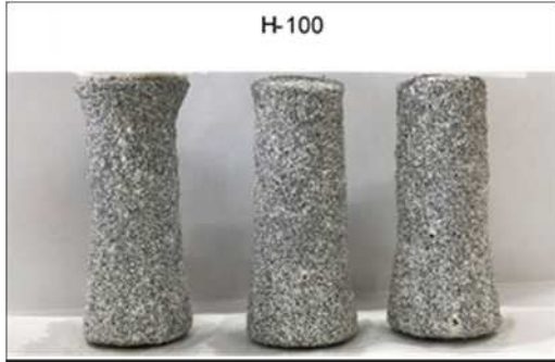
写真-3 H-100 (硫酸 5%溶液浸漬 6 週間)
