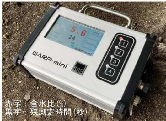
写真-2 簡易型 RI 水分計 計測状況
