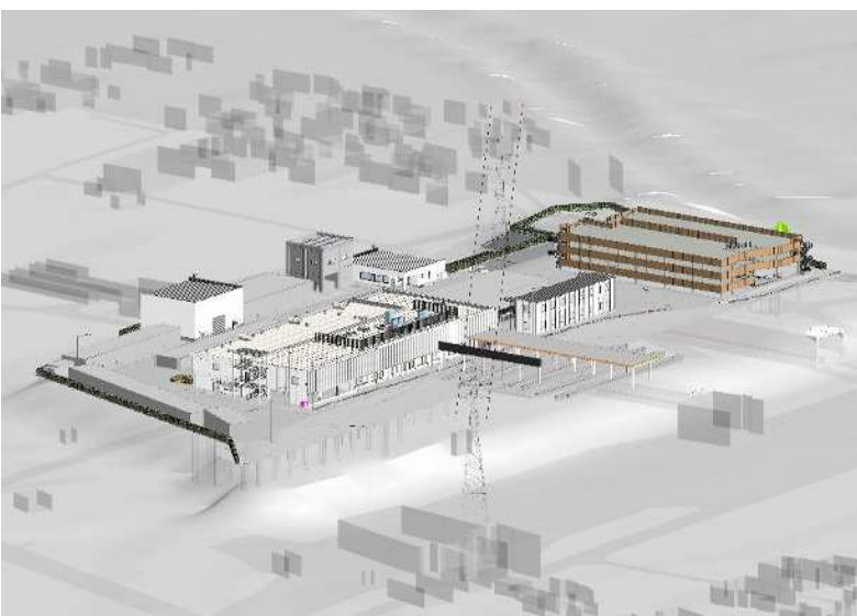
図-32 完成イメージ 3D モデル (BIM モデルと PLATEAU データ合成)
