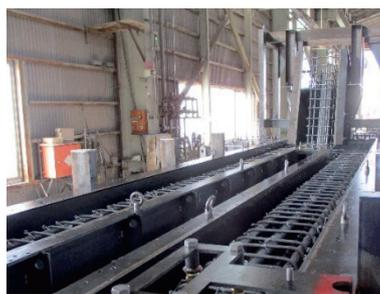
写真-1 斜め柱製作状況
